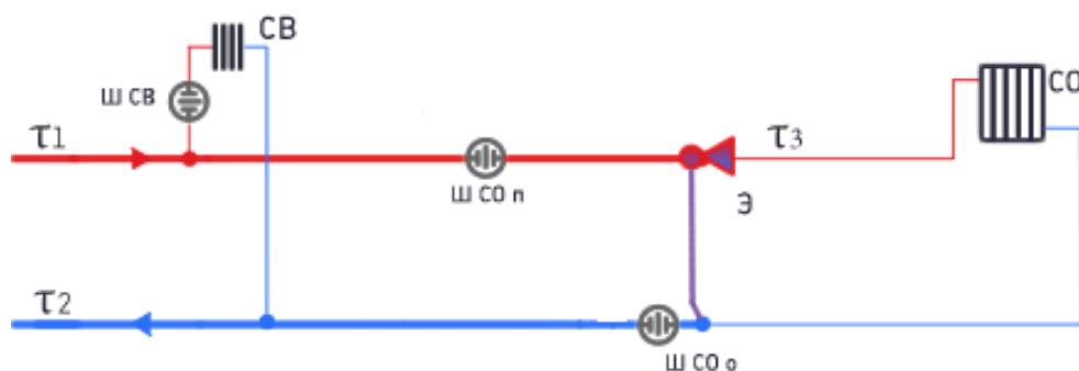
Рисунок 4 – Схема подключения потребителей к двухтрубной тепловой сети (при наличии внутренней системы отопления), зависимое присоединение, с смещением
