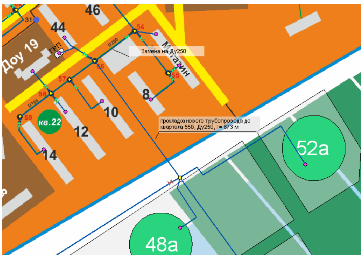
Рисунок 7. Замена существующего участка тр-да и прокладка нового тр-да в направлении квартала 55б
